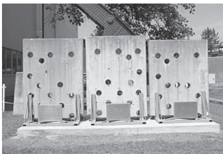
11 高品質リサイクルコンクリート壁試験体 → P. 26 [船橋キャンパス]
