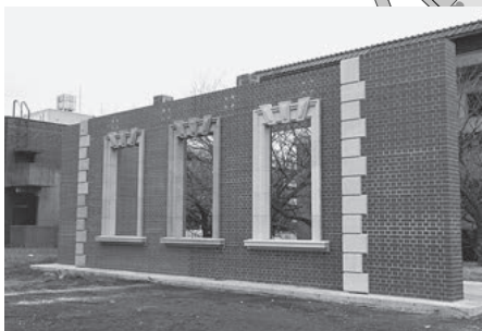
10 『旧三菱一号館』復元のための煉瓦壁試験体 → P. 25 [船橋キャンパス]
