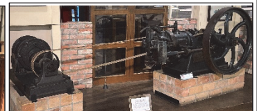
ガスオルガン 英国ホンスビー社製 3 馬力ガスエンジン
