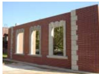
2004年に、丸の内再開発のシンボルとしてこの旧三菱一号館の復元計画が着手されました。ここに展示された煉瓦壁体は、この復元計画の一環として当時の建物の一部を忠実に再現したものであり、耐震的に弱点とされる煉瓦壁体の面外方向の地震時挙動を明らかにすることを目的に実施された加力実験用の試験体として使用されました。実験は、2005年12月、海洋建築工学科の安達・中西研究室と株式会社三菱地所設計の共同によって煉瓦組積体の圧縮試験、せん断試験、面内および面外曲げ試験と併せて実施され、十分な耐震強度を有することが確認されました。
