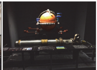
奥 自己浮上型海底地震計 手前 地質調査用エアガン
